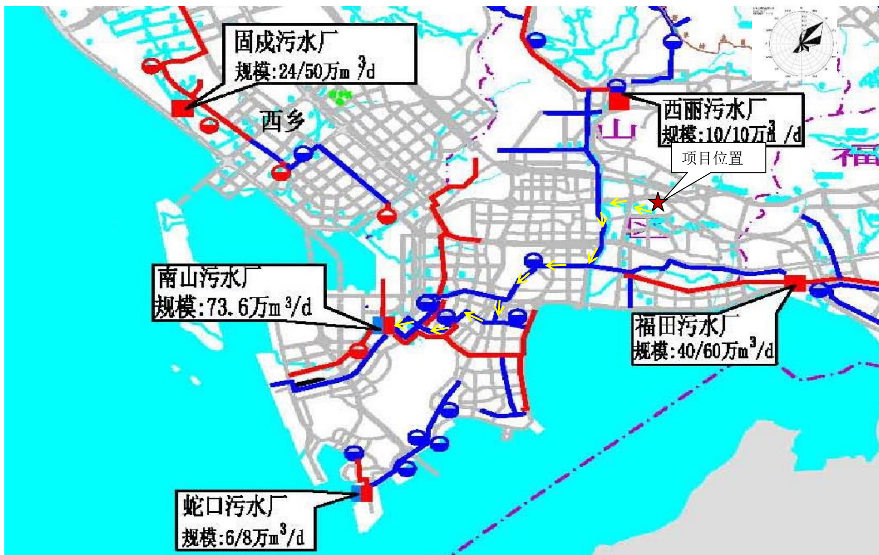
附图 10 项目所在区域污水管网图
