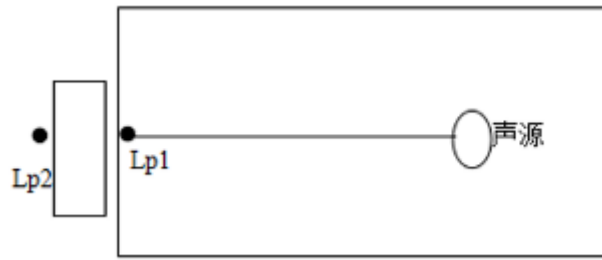
图 4-2 室内声源等效为室外声源图例
