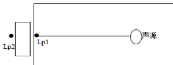
图 4-1 室内声源等效为室外声源图例
