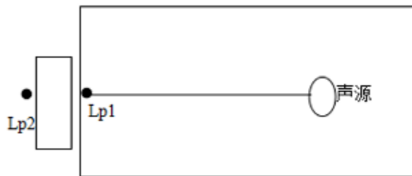
图 4-1 室内声源等效为室外声源图例
