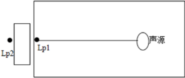
图 4-2 室内声源等效为室外声源图例
